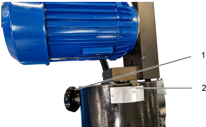
Abb. 12. Einstellung Schärfwinkelskala \alpha
