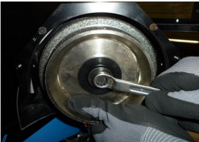
Abb. 35. Wechsel der Schleifscheibe
