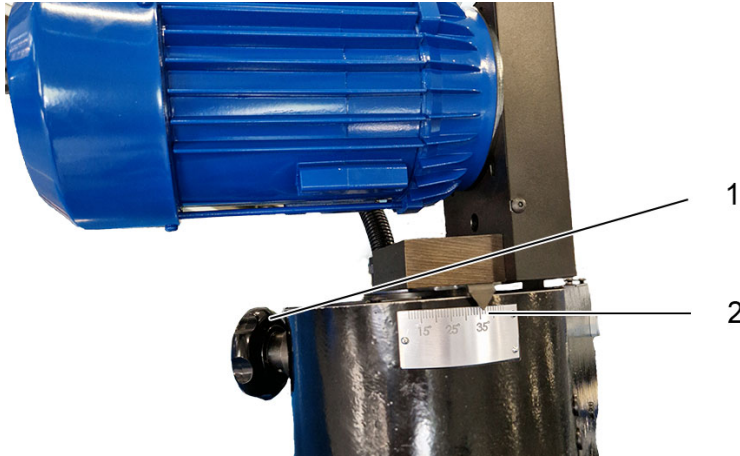
Figure 12. Réglage de l'échelle de l'angle d'affûtage \alpha
