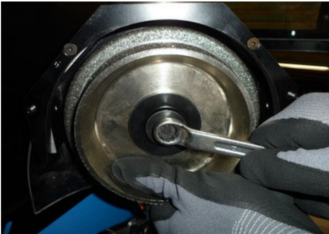
Figure 35. Remplacement du disque d'affûtage
