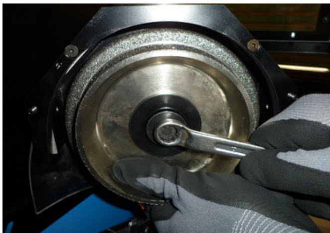
Bild 35. Byte av slipskiva
