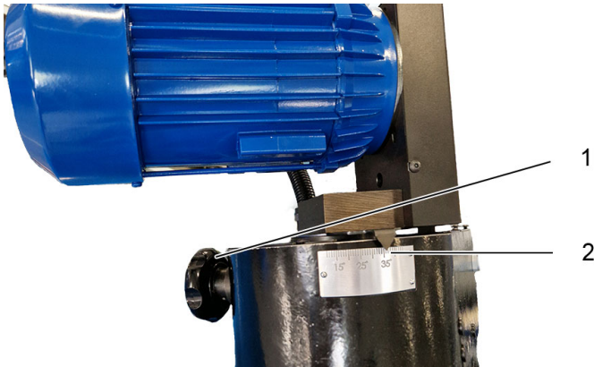
Abb. 14. Einstellung Schärfwinkelskala \alpha
