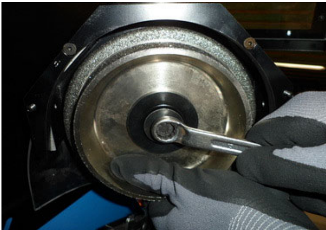
Figure 38. Remplacement du disque d'affûtage
