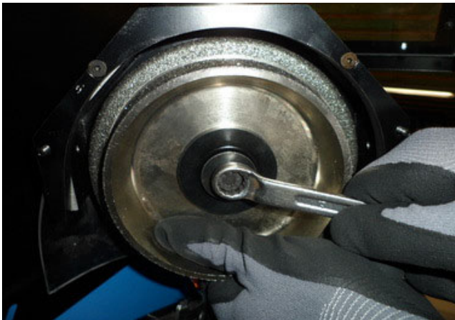
Bild 38. Byte av slipskiva
