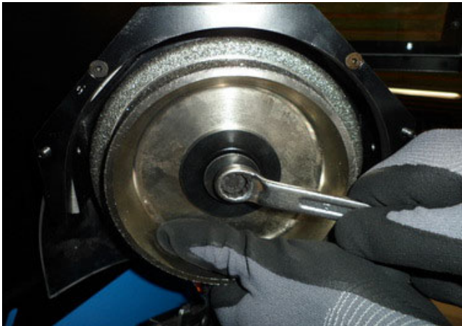
Figure 41. Remplacement du disque d'affûtage
