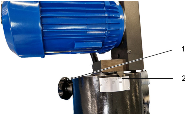
Figure 14. Réglage de l'échelle de l'angle d'affûtage \alpha
