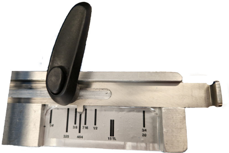
Figure 11. Rail de réglage - pas de la denture
