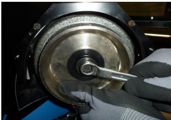
Bild 44. Byte av slipskiva
