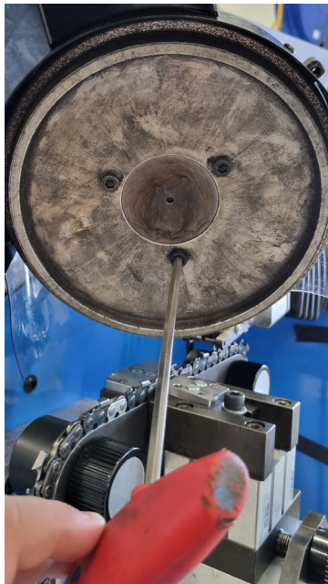
Abb. 42. Wechsel der Schleifscheibe
