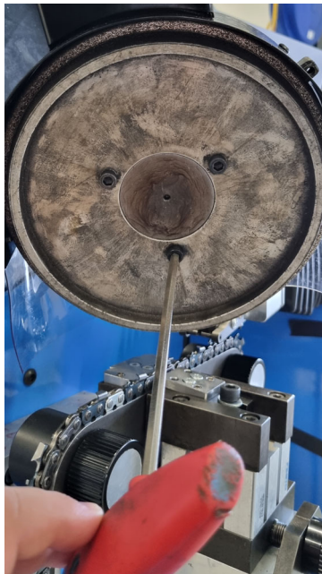
Bild 42. Byte av slipskiva
